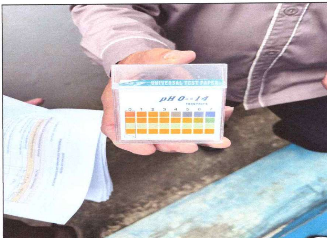
Gambar 8 Test PH untuk mengetes Air Limbah yang dihasilkan
